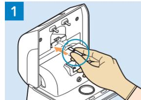
1 センサーチップを機器本体の挿入口に挿入します
